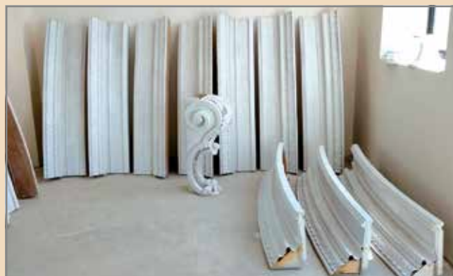
Partijiet mill-ġnub waqt il-proċess ta' żebgħa bl-undercoat
