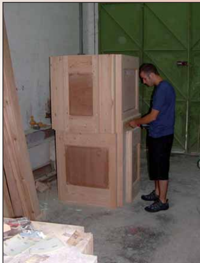
Is-Sur Matthew Ellul, waqt il-hidma tiegħu fuq sett ta' tmien pedestalli ohra għal Triq Karmenu Ciantar. Dawn qed jinħadmu b'injam solidu u fuq sistema ta' minċotti.
